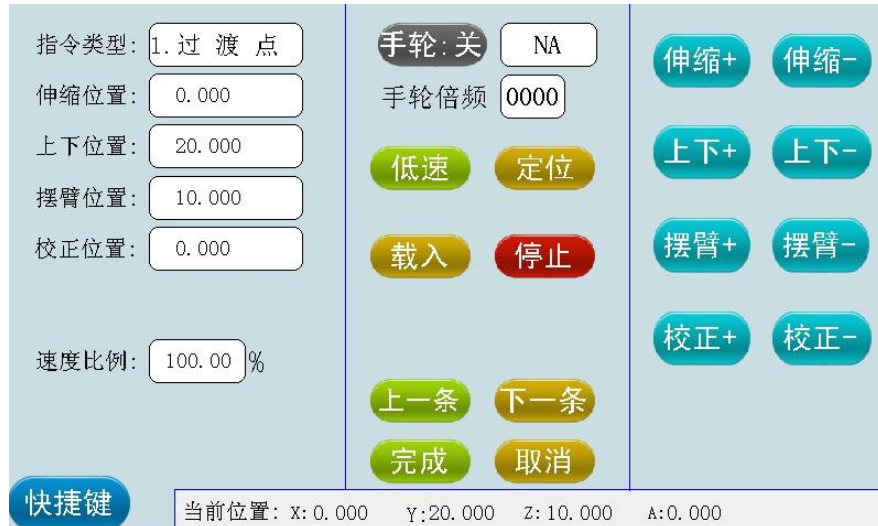
图 3.1.14 过渡点指令编辑界面 注意：过渡点一般用作避开障碍物使用，机械手在取料或放料的时候，有些时候不能一步到位，必须设置过渡点以避开障碍物。
