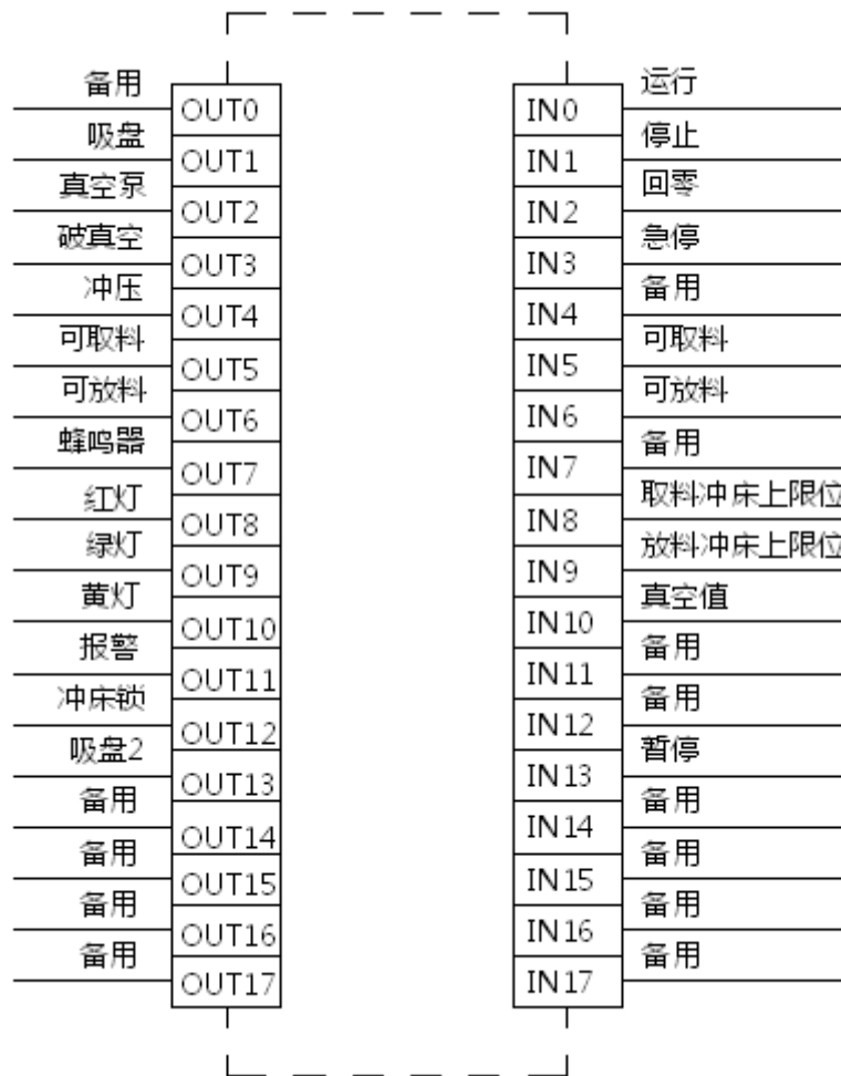
图 4.4.1 通用 IO 口定义
